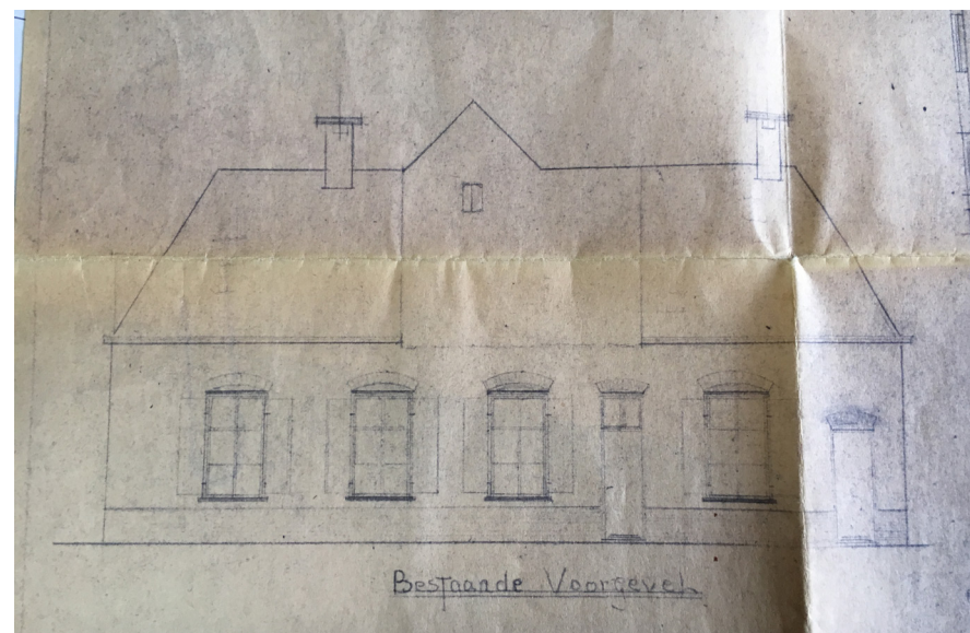
Afb. 17 Tussen 1910 en 1960 is de boerderij gewijzigd in een model met een volwaardig voorhuis. Het rietdek op het voorschild verandert steeds mee met de plannen.
