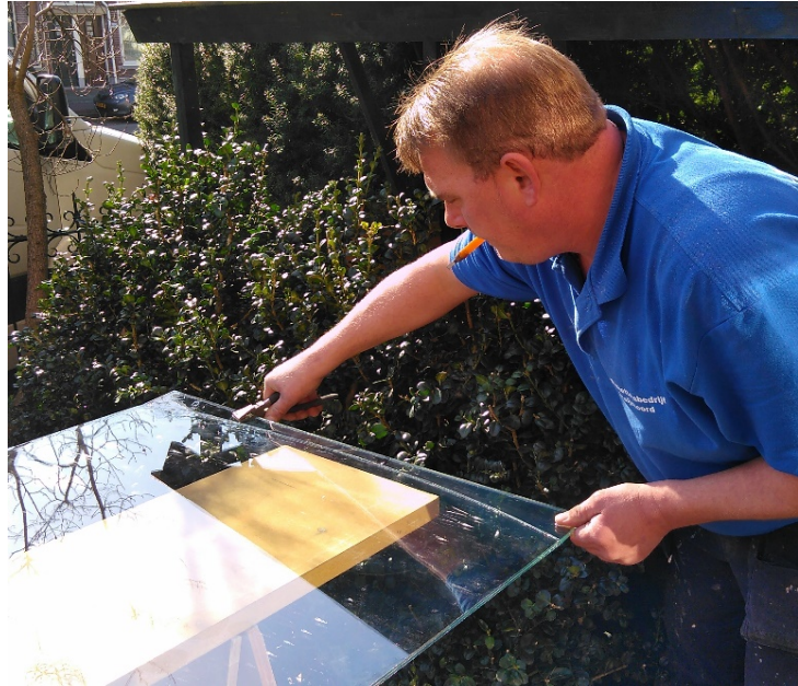
Glazenier in actie bij het snijden van een toogvorm voor isolerend glaslaminaat van ca. 7 mm totaaldikte. Tweezijdig insnijden van het glas en doorsnijden van de hechtlaag bepalen de bewerking. © ejn
